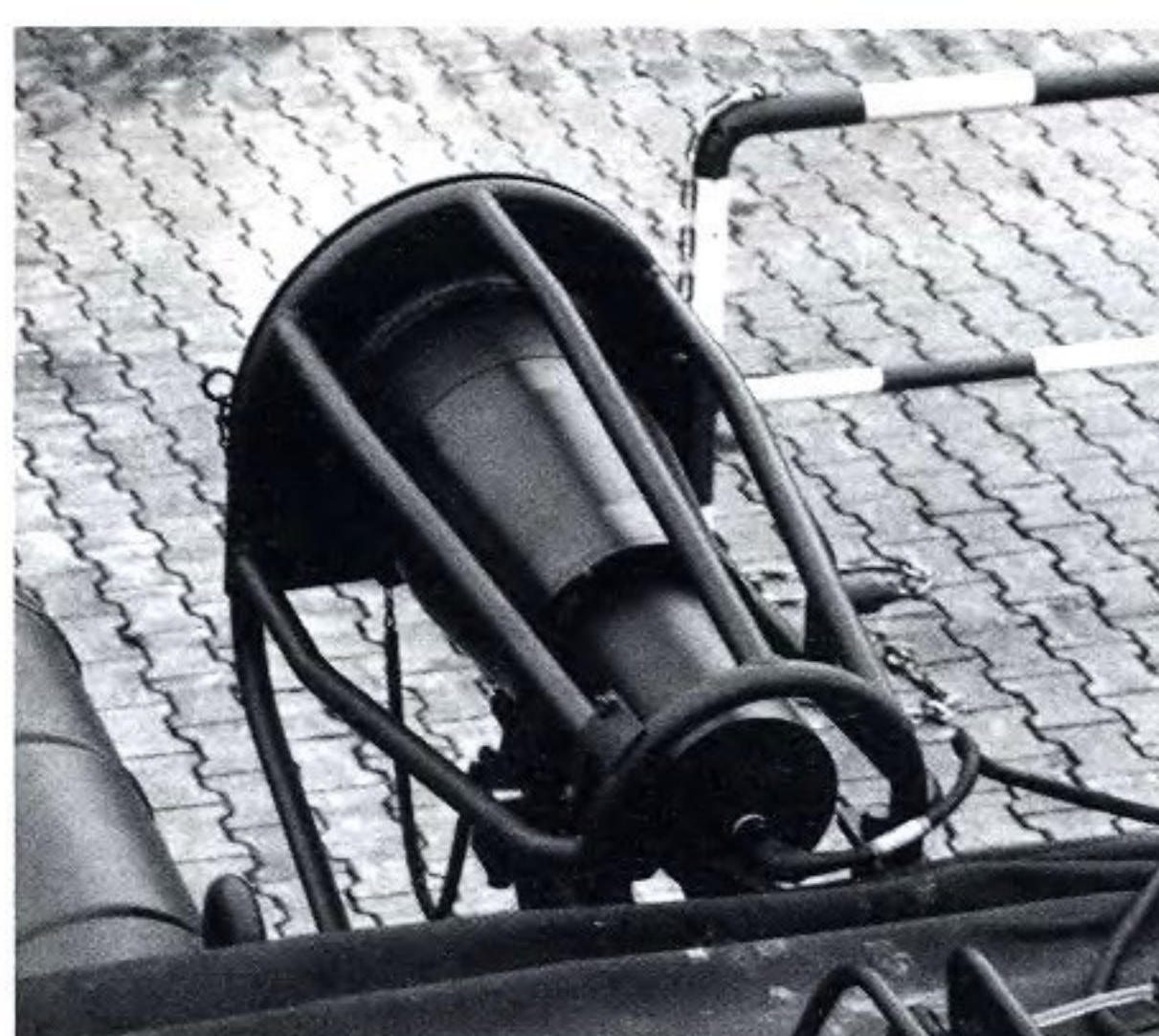
Ein PZB 200 aufgebaut und angeschlossen im Käfig an einem 1A3A1. Die Schutzklappe ist geschlossen. A PZB 200 mounted in the cage (with connections fitted) of a Leopard 1A3A1 MBT. The protective cover is closed.
