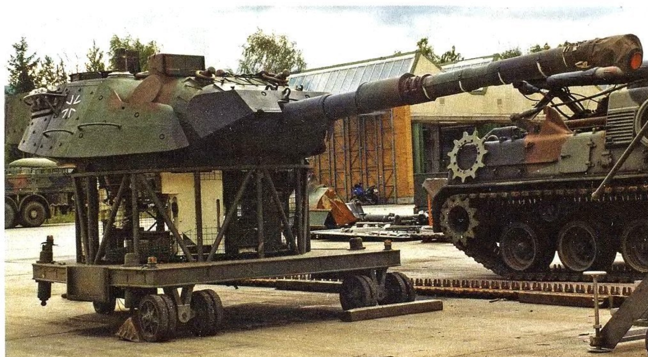
Ein gezogener Leopard 1A5 Turm in einem speziellen Lagerungsgestell. Diese Gestelle waren im Instandsetzungszug der Panzerbataillone in der Regel nicht vorhanden. Beachte die montierten Poller zum Turmziehen. Rechts steht ein Bergepanzer M 88 A1 GE. A lifted Leopard 1A5 turret in the depot frame mounting. These frames were not part of the standard equipment set of the maintenance platoon of a tank battalion. Note the fixed lifting eye for lifting the turret. On the right a M 88 A1 GE Armoured Recovery Vehicle (ARV). (GBO)
