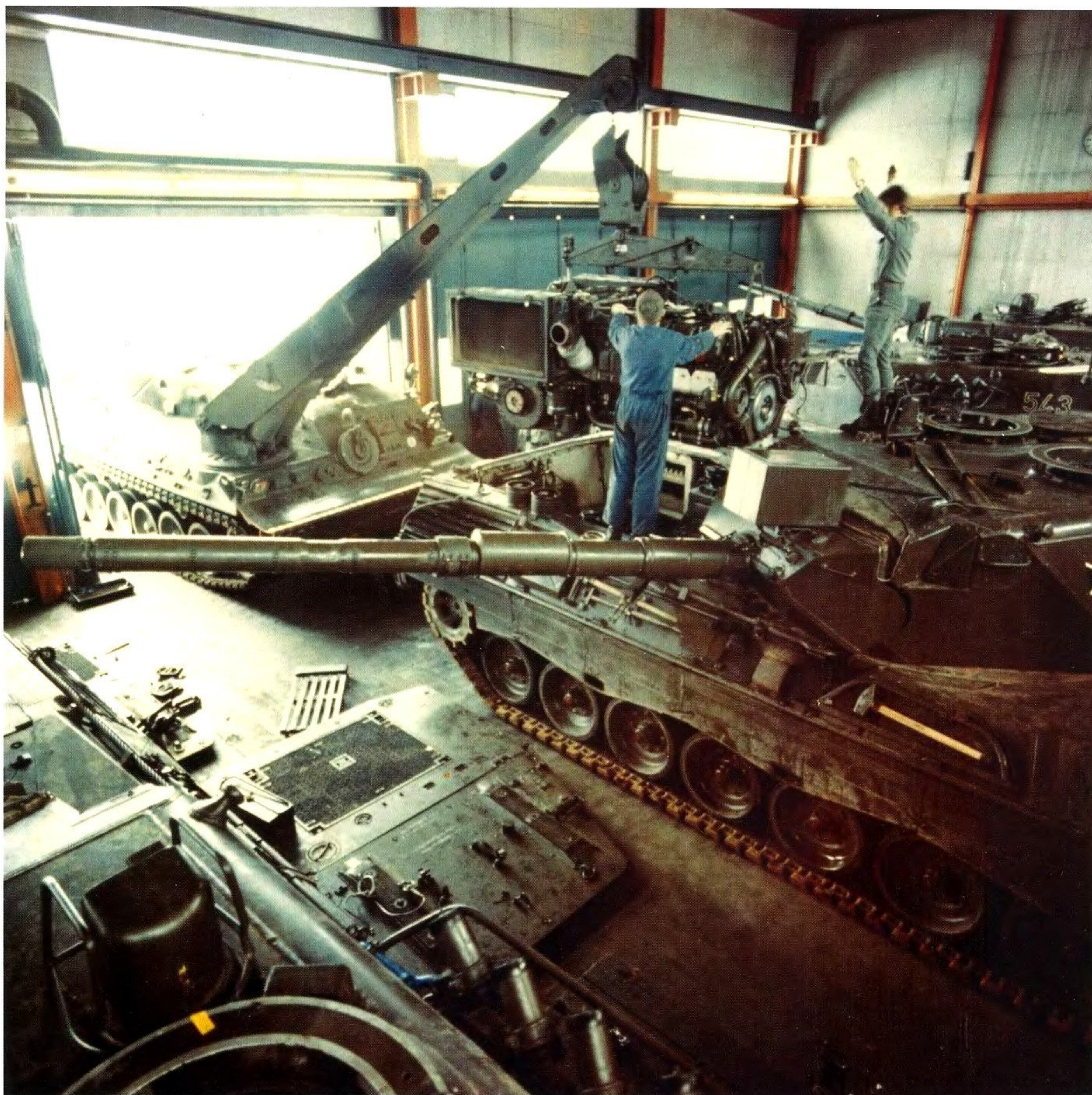
Triebwerkziehen, hier an einem Leopard 1A4. Die Triebwerkraumabdeckung wurde zwischen den Panzern abgelegt. Turret lifting shown on a Leopard 1A4. The engine compartment cover plate has been placed between the two vehicles. (KMW)
