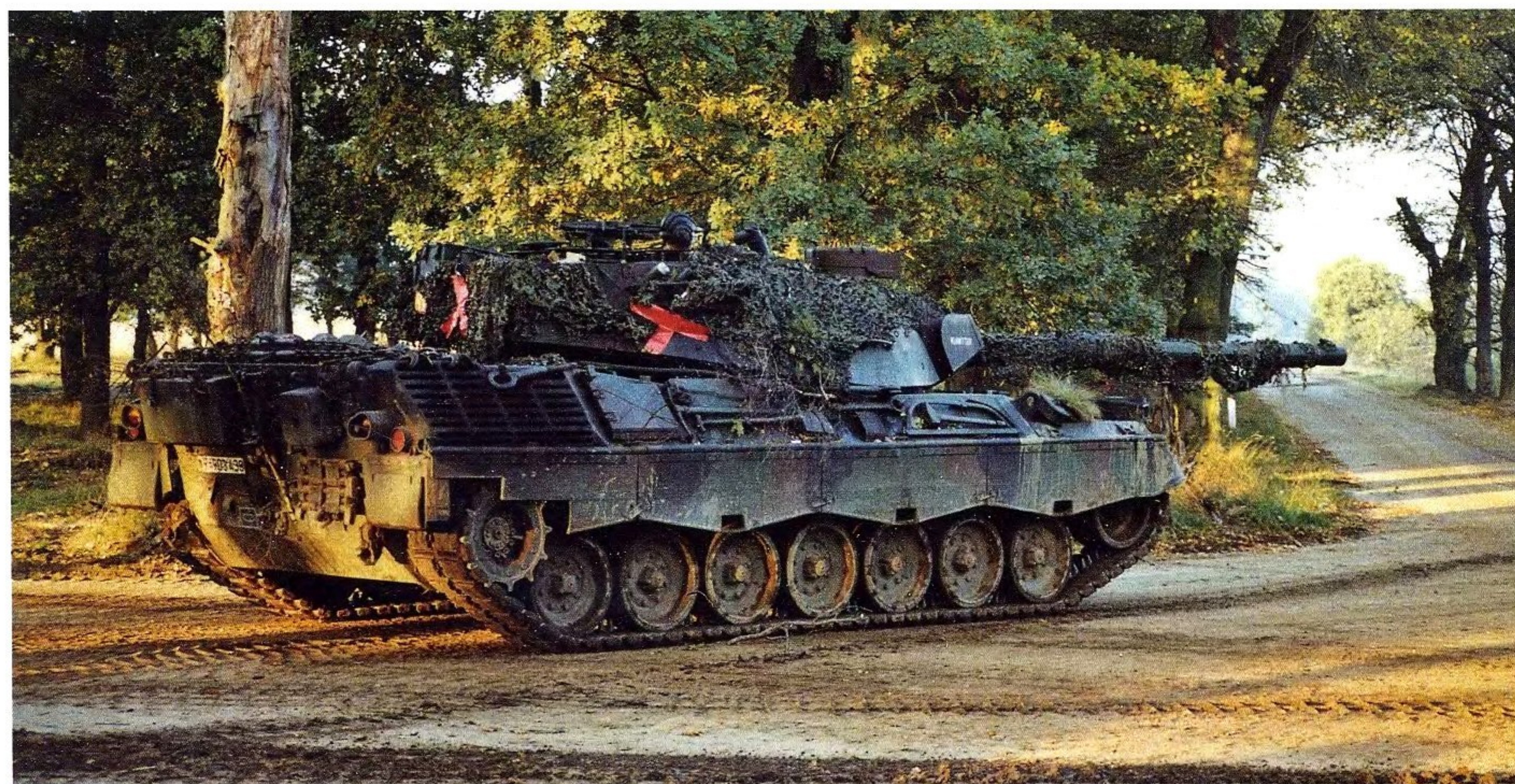
Die roten Kreuze ordnen diesen Leopard 1A5 einer Übungspartei zu. Beachte das von der BK abgekoppelte TRP. In dieser Position nimmt es dem Kommandanten im Inneren am wenigsten Platz weg. Die Außenbordsprechstelle ist quadratisch. The red crosses show that this Leopard 1A5 belongs to a training party. Note the turret surveillance periscope (TRP) de-coupled from the main gun. In this position the device saves the most space available for the commander inside the turret. The infantry telephone box is rectangular. (CS)
