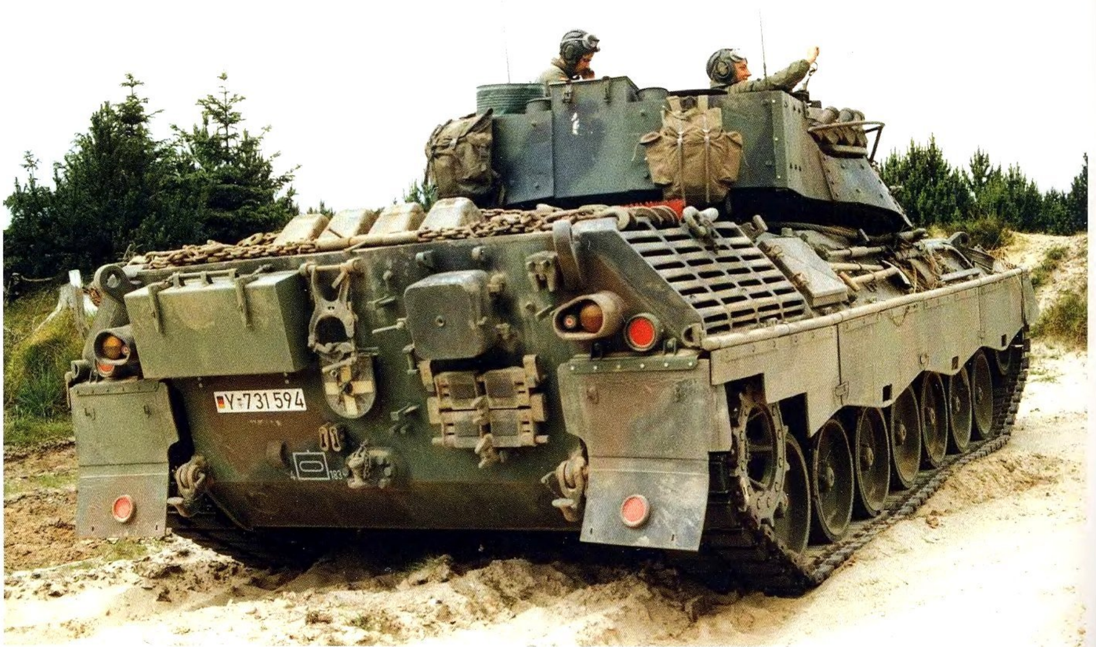
Die 4./PzBtl 183 während einer Übung mit Leopard 1A5 auf dem Truppenübungsplatz Oksbøl in Dänemark im Jahre 1996. Quer über das Heck werden die Verzurrketten für den Eisenbahntransport mitgeführt. Dazwischen liegen die Unterlegkeile. 4 th Company, 183 rd Tank Battalion during an exercise with their Leopard 1A5 MBTs on the Oksbøl training ground in Denmark, 1996. The tie-down chains for railroad transport are carried across the tank's rear. Between them the wheel chocks. (PS)
