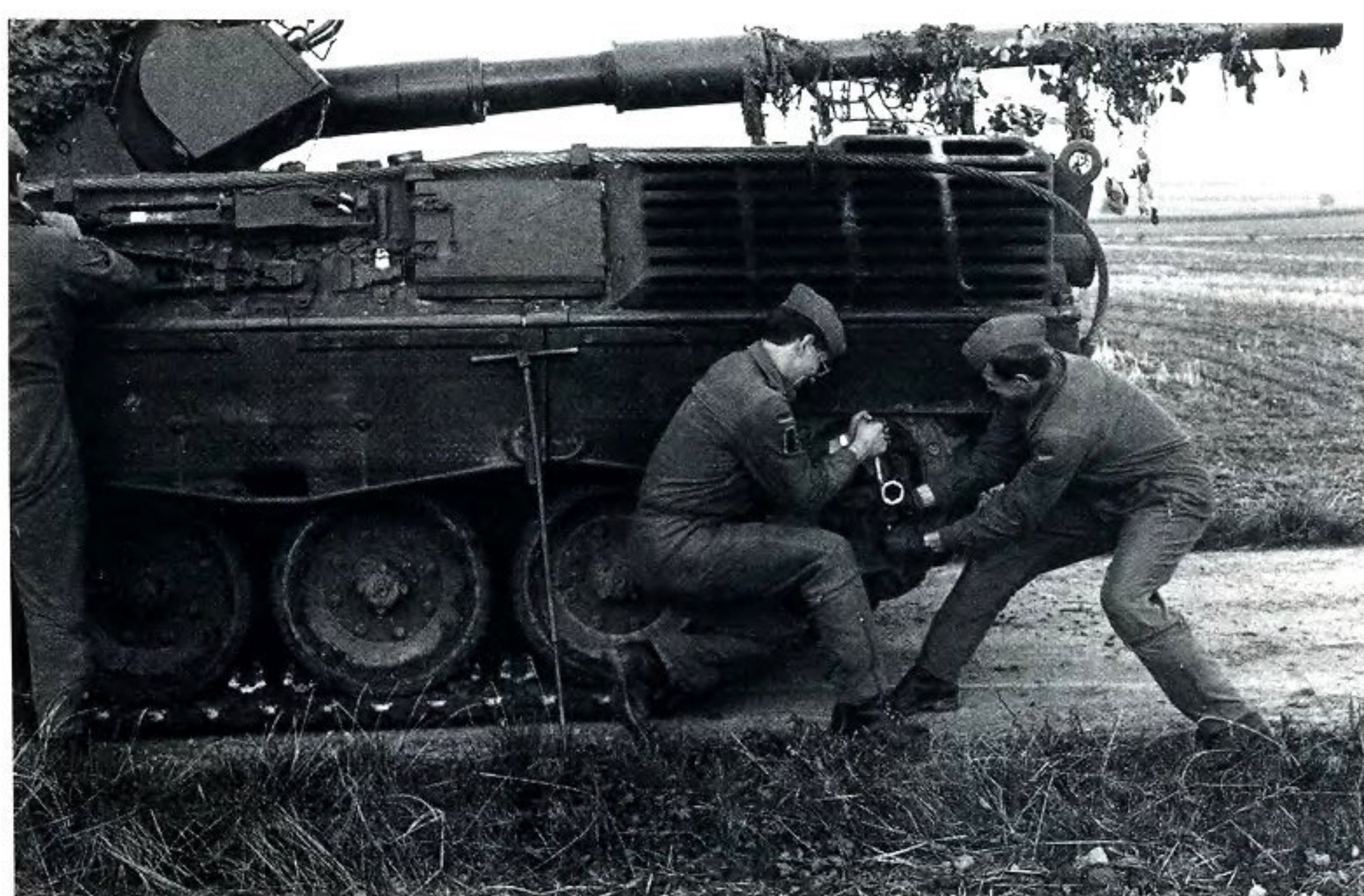
Das Seitenvorgelege stellt die Verbindung zwischen Triebwerk und Laufwerk dar. Zum Triebwerkziehen und zum Abschleppen über weitere Entfernungen muss das Seitenvorgelege getrennt werden. Das Werkzeug dazu wird auf der vorderen Triebwerkabdeckung mitgeführt. The final drives are the connective element between the powerpack and the suspension system. For the exchange of the powerpack and for towing operations the final drives have to be disconnected. The corresponding tool set is carried on the forward part of the engine compartment cover plate. (JV)
