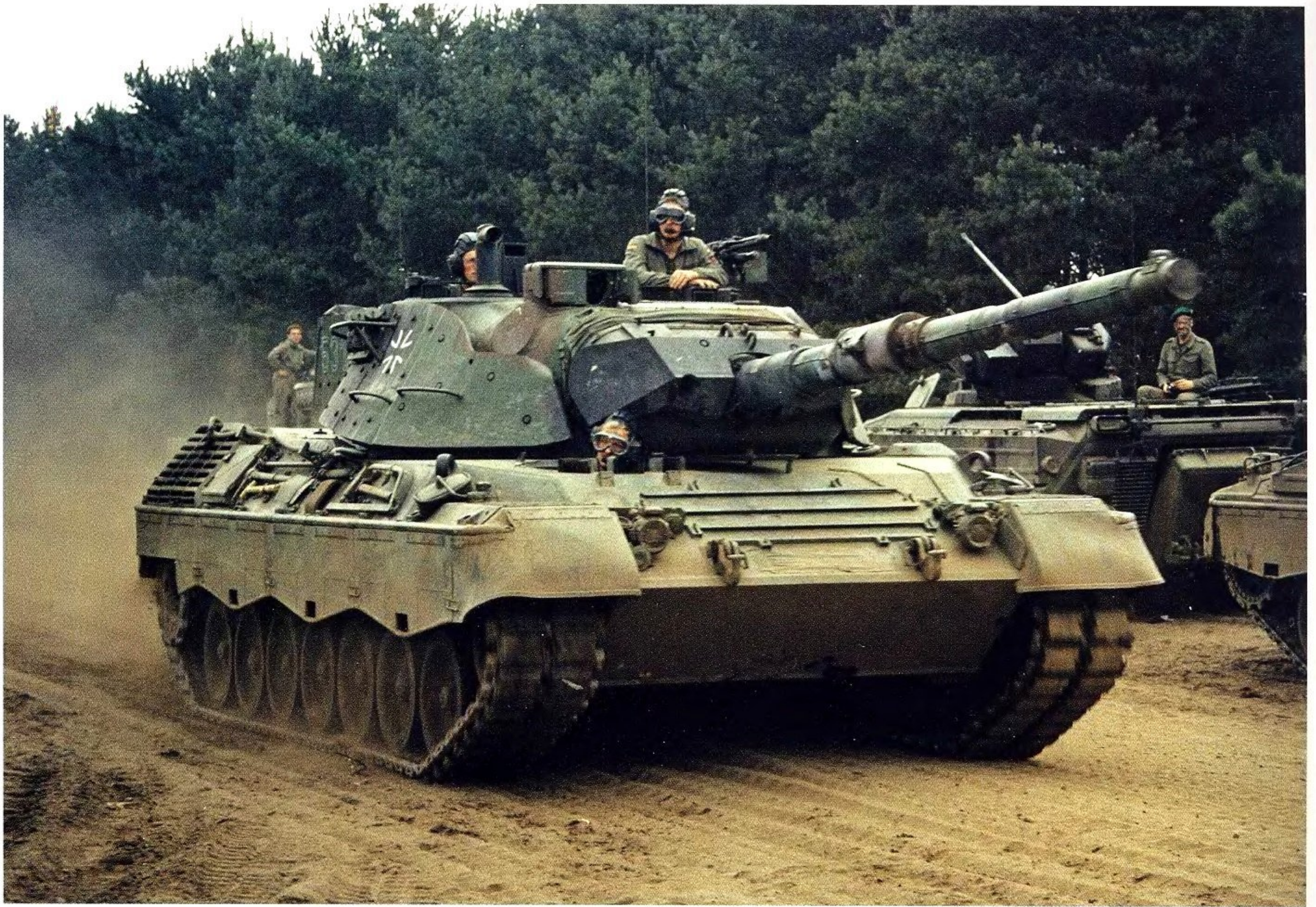
Ein Leopard 1A5 passiert mehrere Schützenpanzer Marder 1A3 auf dem Übungsplatz in Munster, 1988. Beide wurden im Laufe ihrer Dienstzeit mit einer Zusatzpanzerung ausgestattet. Beim Leopard war dies ab 1975 während der Kampfwertsteigerung vom 1A1 zum 1A1A1 der Fall. A Leopard 1A5 passing several Marder 1A3 AIFV on the training ground in Munster, Germany, 1988. Both vehicles had been retrofitted with an add-on-armour system during their in-service period. The Leopard I received this measure during the modernisation programme from 1A1 to 1A1A1. (JV)
