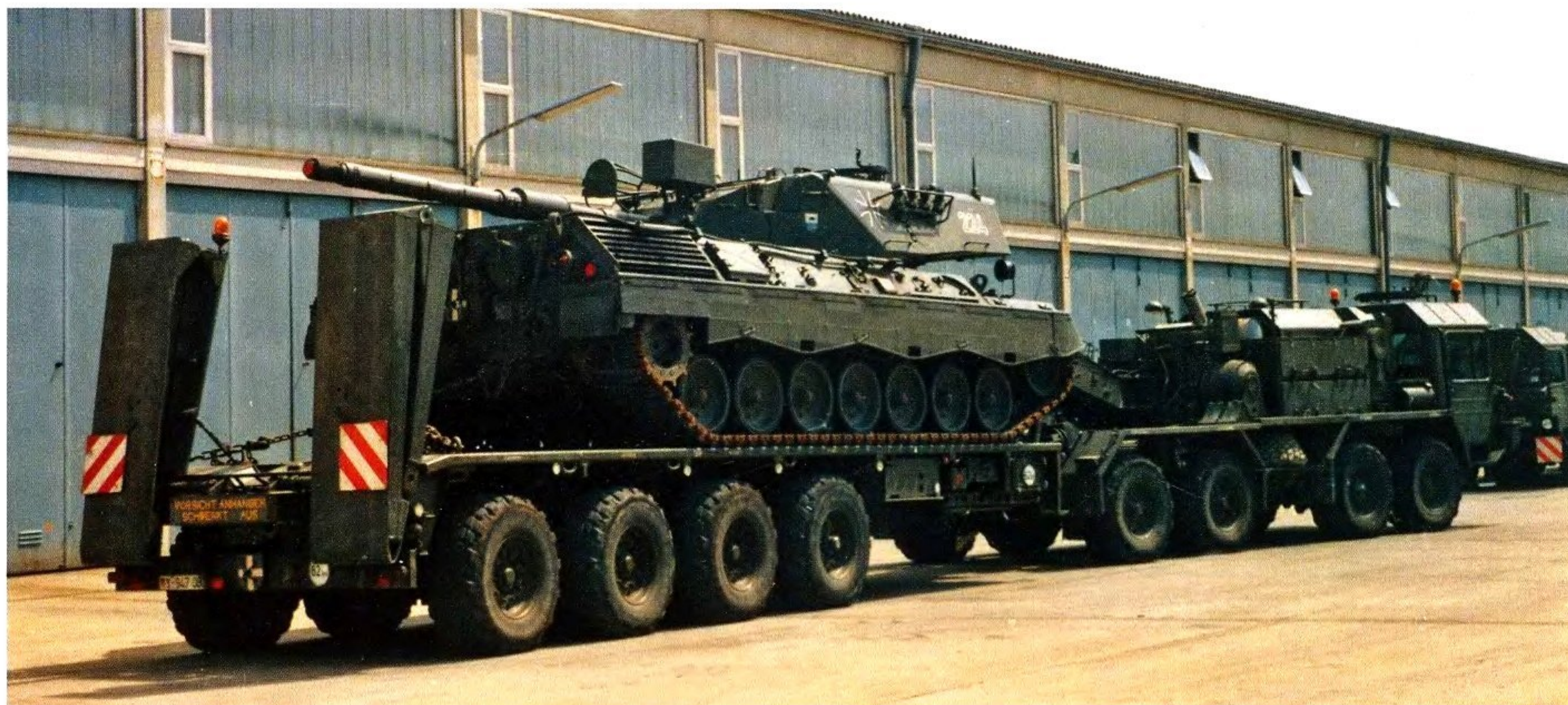
Ein Leopard 1A3A1 auf einem SLT. Bei Nichtgebrauch wurde die PZB-Kamera in einer Halterung innen im Turmheck mitgeführt. A Leopard 1A3A1 loaded onto a German SLT tank transporter. If not in use the camera for the PZB device was carried within the turret at the rear. (WL)
